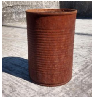
Figura 4. Fotografía lata de metal que presenta corrosión.
