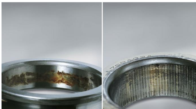
Figura 27. Anillo exterior de un rodamiento cilíndrico y anillo interior de un cojinete, en ambos se presenta corrosión-desgaste. [43]
