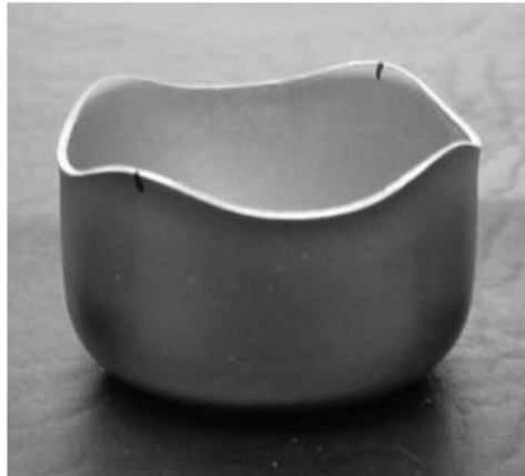
Figura 10. Defecto de orejeadado en un proceso de embutido profundo debido a la anisotropía de la lámina. El material de las orejas deberá ser recortado y descartado [Randle & Engler, 2000]
