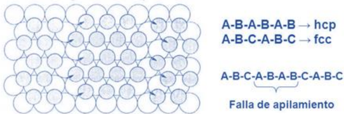
Figura 10.26 Representación esquemática de errores de apilamiento en una estructura cristalina. (Adaptado de J.D. Verhoeven, Fundamentals of Physical Metallurgy , Wiley 1975.)
